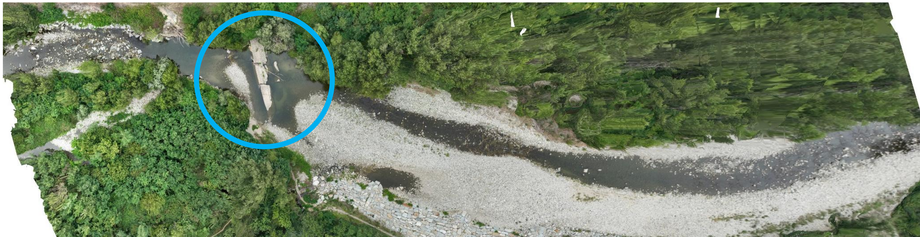
Dettaglio dell'ortofoto ottenuta dopo elaborazione della nuvola di punti
